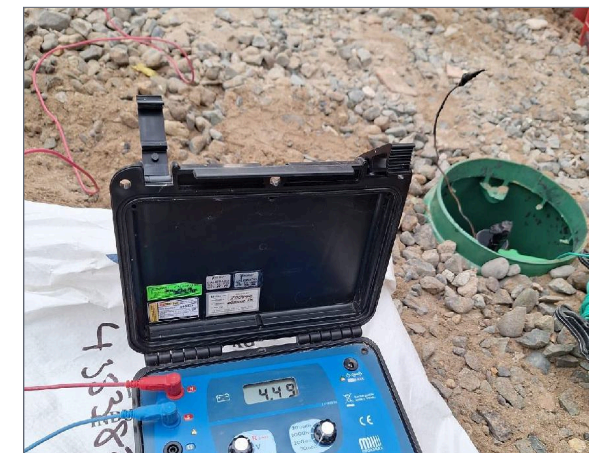
Medición de resistividad para sistemas de puesta a tierra
