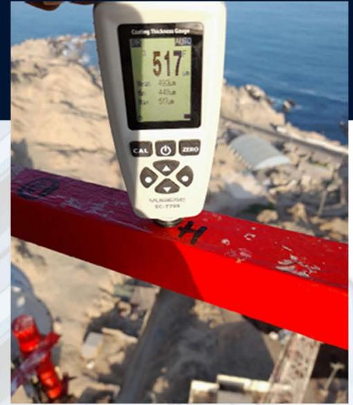
Medición de espesor de recubrimientos
